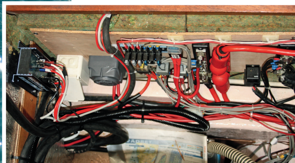
OVAN: Balmar 612 till vänster och spänningsreläet intill, tyvärr sitter denna panel i kläm mellan två faror. Dels vatten då detta är intill kölsvinet, dels värmen då vi är i motorrummet. VÄNSTER: Här ser man de bägge standardpanelerna, numera längre bak och ihopflyttade, samt flexipanelen på biminutaket.
