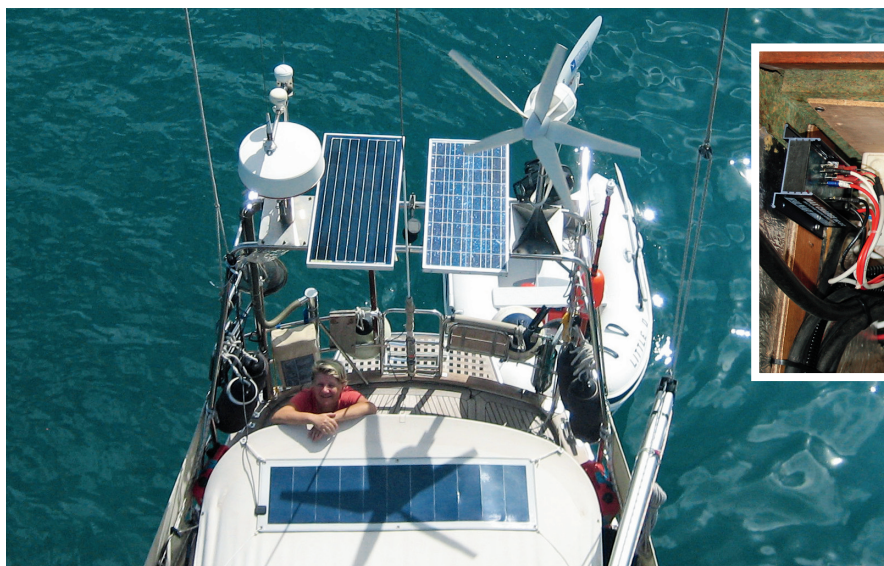
OVAN: Balmar 612 till vänster och spänningsreläet intill, tyvärr sitter denna panel i kläm mellan två faror. Dels vatten då detta är intill kölsvinet, dels värmen då vi är i motorrummet. VÄNSTER: Här ser man de bägge standardpanelerna, numera längre bak och ihopflyttade, samt flexipanelen på biminutaket.
