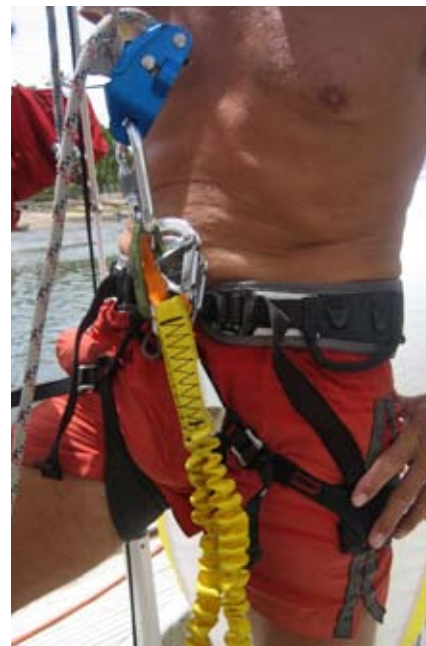
Selen har fullt med praktiska hakar så man får lätt med sig allt man kan behöva för mastjobbet. Observera den blå Gri-Grin som gör att man klarar klättringen ensam.
