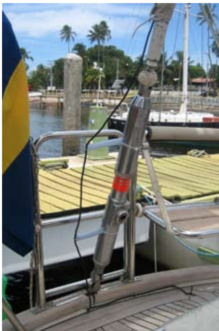
AKTERSTAGET: På akterstagssträckaren har jag satt orange tape, en markering för varje mm upp till 6 mm vilket är max vad man ska (eller vågar) spänna = 30% av brottslasten.
