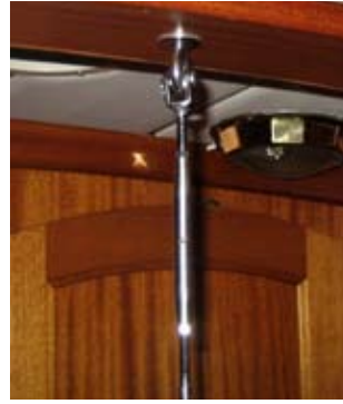
INRE FÖRSTAG: En 8 mm ringbult gängades fast i däcksbalken, på vilken jag monterade en vantskruv med wire och ögla som sedan fästes i ett nytillverkat bottenbalkbeslag.
